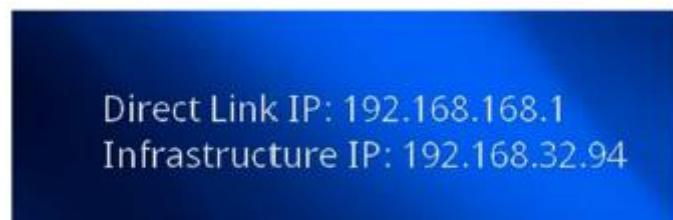
( EZCast Pro Box2 を外部 Wi-Fi ネットワークに接続している時は、インフラストラクチャ IP を使用してアクセスします。EZCast Pro Box2 の Wi-Fi に直接接続している場合は、192.168.168.1 を介してアクセスします。)
